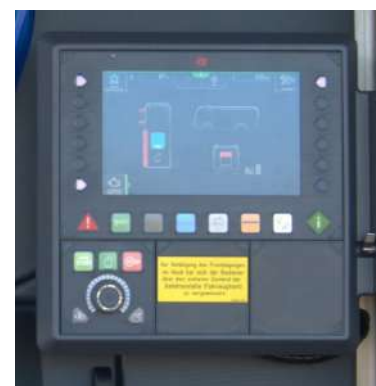
Das RBC LCS: Der Maschinist kann vom Pumpenbedienstand aus zahlreiche Fahrzeugfunktionen steuern
