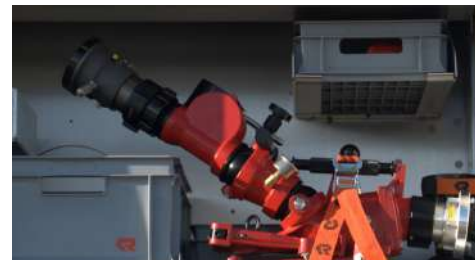
Wasserwerfer RB6: Einsatzgebiet für Löschangriffe, zur Kühlung oder als Wasserschild
