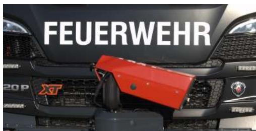
Elektronisch gesteuerter Werfer RM15: Bis zu 1.900 l/min bei 10 bar Wasser & eine Wurfweite von bis zu 70m
