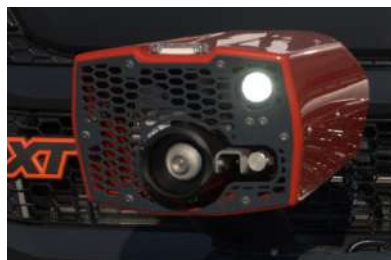
Elektronisch gesteuerter Werfer RM15: Bis zu 1.900 l/min bei 10 bar Wasser & eine Wurfweite von bis zu 70m
